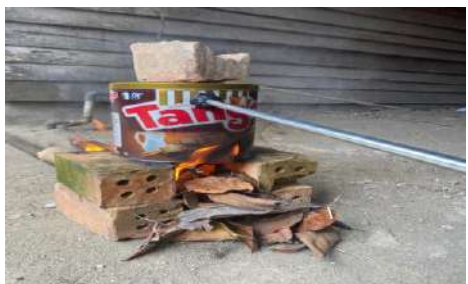
Uji coba pembuatan teknologi pengubah sampah menjadi minyak dilapangan
