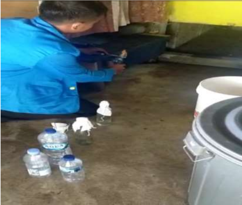
Gambar 5. Prosedur sterilisasi ujung botol depot B
