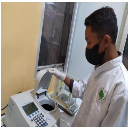
Gambar 1.9 Pengujian Degradasi Limbah Cair Zat Warna Batik Jambi Menggunakan Spektrofotometer UV-VIS Tipe Single Beam
